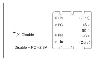
*Figure 2* — *Module enable/disable.*
